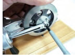
3.M5のプラグを外し、ピストンを引き抜きます。
